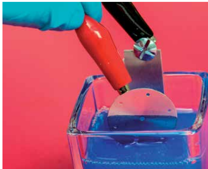
Electrodéposition d'un vernis sur un cadran de montre.
