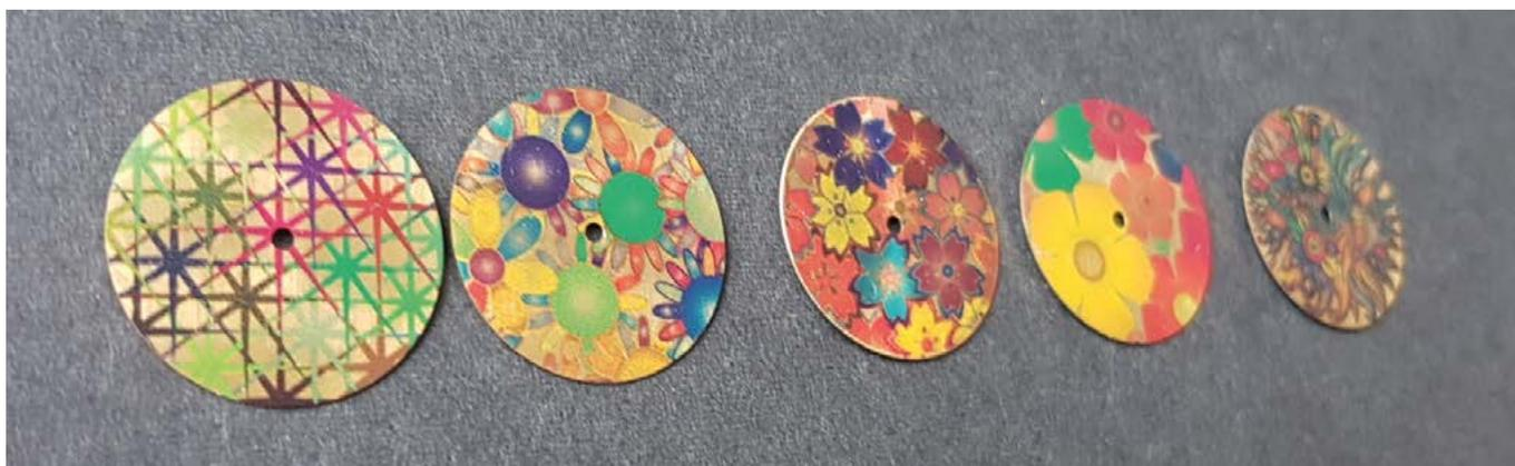
Figure 12: Impression inkjet UV de cadran d'entrée de gamme.
