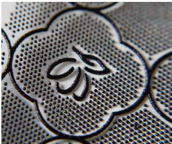
Figure 10: Impression 3D avec des reliefs de 0.8mm.
