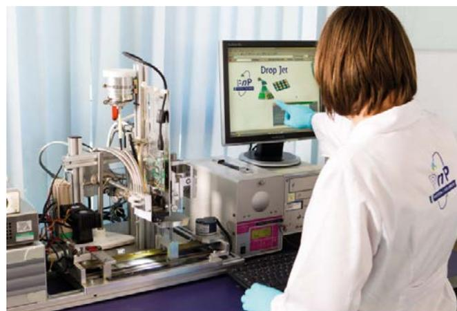
Figure 9: Dispositif d'impression digitale-laboratoire UV basé sur une tête Xaar-1001.
